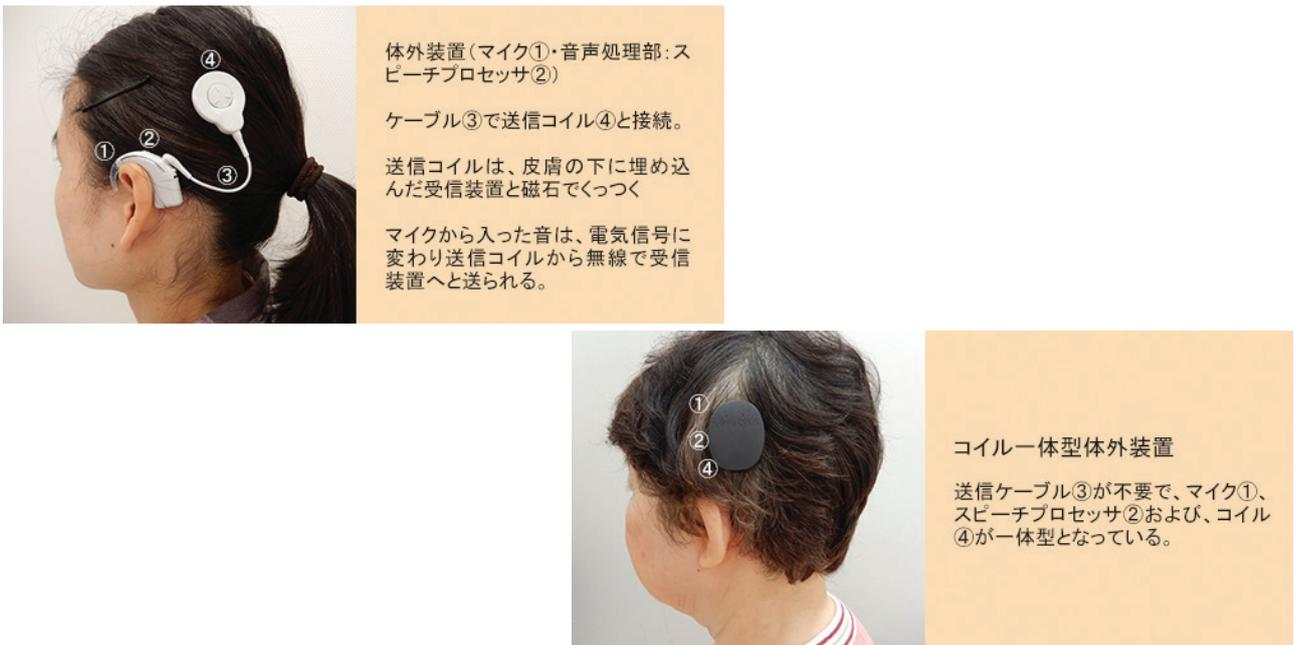
図2 人工内耳の体外装置(耳掛け型(左)とコイル一体型(右))
